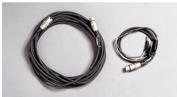
Cables del transductor GA-00041 y GA-00042
